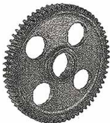
corpo com 4 furos, cubo e furo central
